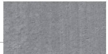
Svepelektronfotografi av smörjmedelsskiktet hos en MoS 2 glidlack efter tribologisk belastning. Ytan hos glidlacken är utjämnad.
