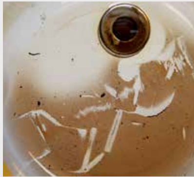
Mittlere thermische Stabilität Moderate Ablagerungen
