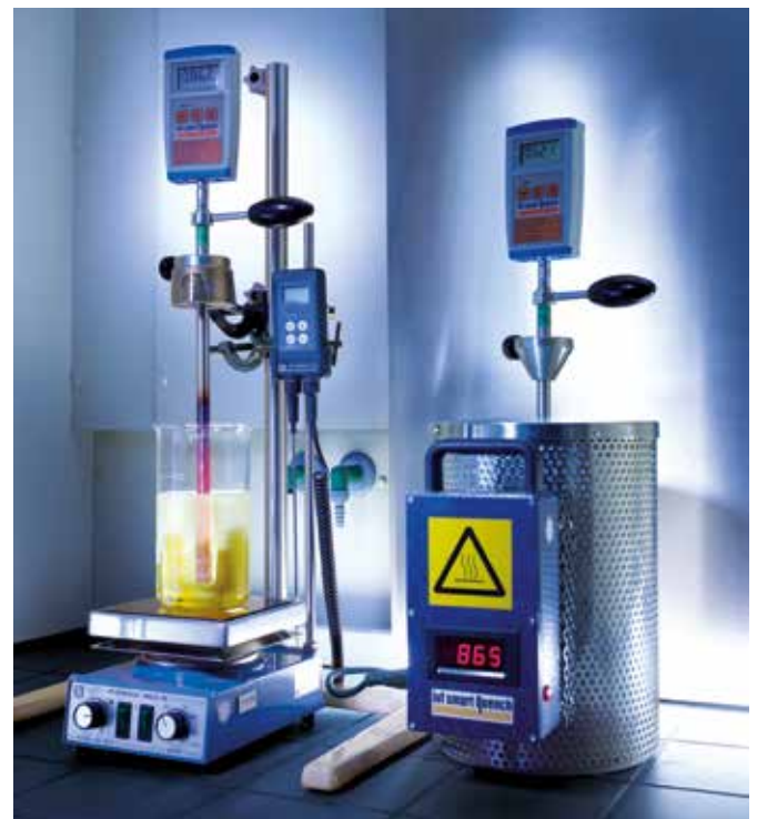
Abbildung 6 – Vorrichtung zur Messung der Abkühldauer
