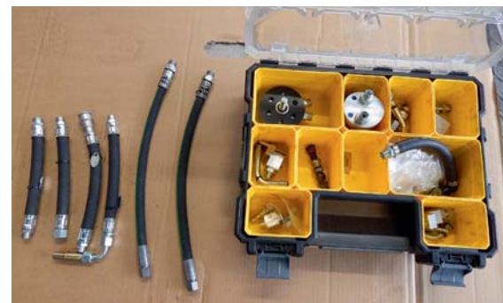
Mittels passender Adapter werden Zu- und Ablauf an den Ölkreislauf angeschlossen.
