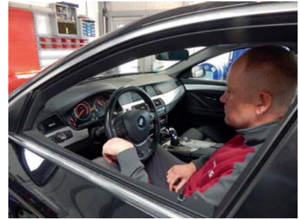
Durchschalten: Während des Spülvorgangs schaltet der Mechaniker alle Fahrstufen durch.
