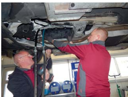
Demontage Ölwanne: Hier hilft der Kollege, um Verschmutzungen zu vermeiden.
