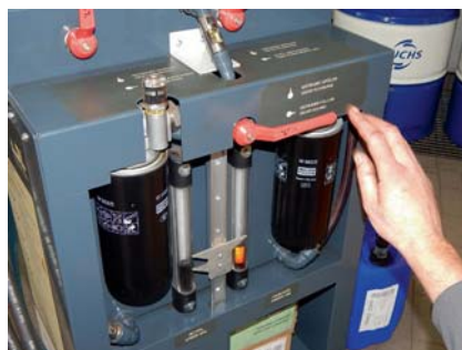
Befüllung: Mit dem Frischöl wird gespült, dazu werden rund zwei Liter Übermenge eingefüllt.
