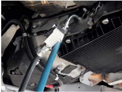
Anschluss: Zu- und Ablauf werden mittels Adapter an den Ölkreislauf angeschlossen.
