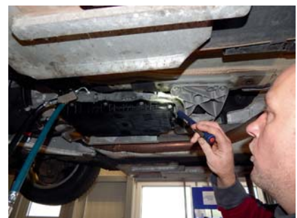
Sichtkontrolle: Der Mechaniker prüft die neue Ölwanne auf Dichtheit.
