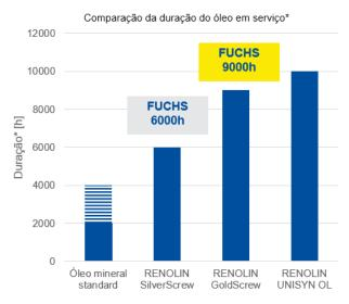
$^{\circ}$ duração do óleo em condições definidas:  $\sim$  85  $^{\circ}$  C de temperatura de descarga / qualidade média do ar ambiente
