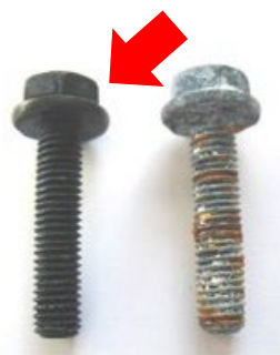
(左) グライトモ165 塗布ねじ 720時間塩水噴霧試験(DIN 50021) 比較
