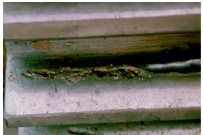
元々のピッチングと処理したピッチング
