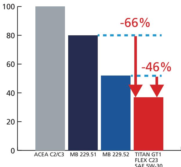
フックス タイタンシリーズはオイルの酸化や粘度増加を防ぐことで性能を長持ちさせます。例えば、TITAN GT1 FLEX C23 SAE 5W-30を用いた試験では、バイオ燃料使用時におけるオイルの酸化や増粘をメルセデスベンツ規格品(MB 229.51)に比べて最大63%抑制し、長期使用においても優れた性能を維持することが証明されています。さらに、Sequence IIH Testによる粘度増加率の評価(40°Cでの粘度変化)では粘度増加率がほぼゼロを記録し、API SP規格を大幅に超える耐久性を実現。過酷な条件でもエンジンを守り、オイル交換まで優れた性能を維持する革新的なエンジンオイルです。
