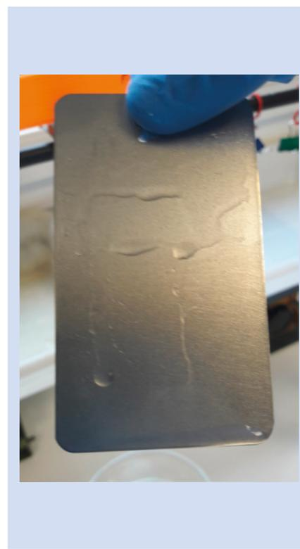
FIGURE 4 : Évaluation du film d'eau sur plaque après dégraissage.
