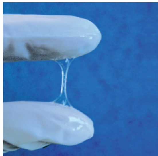
Aceite para guías con «mejorador de la adhesión»
