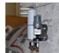
**La presión generada de 6 bares permite montaje a distancia de hasta 5 m**
