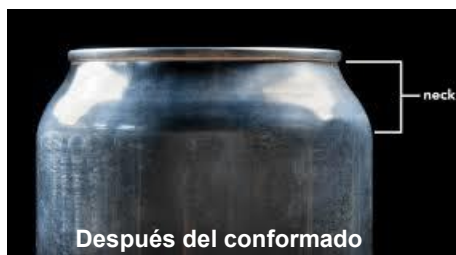
Proceso de conformado de cuello de latas para bebidas
