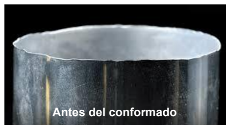
Proceso de conformado de cuello de latas para bebidas
