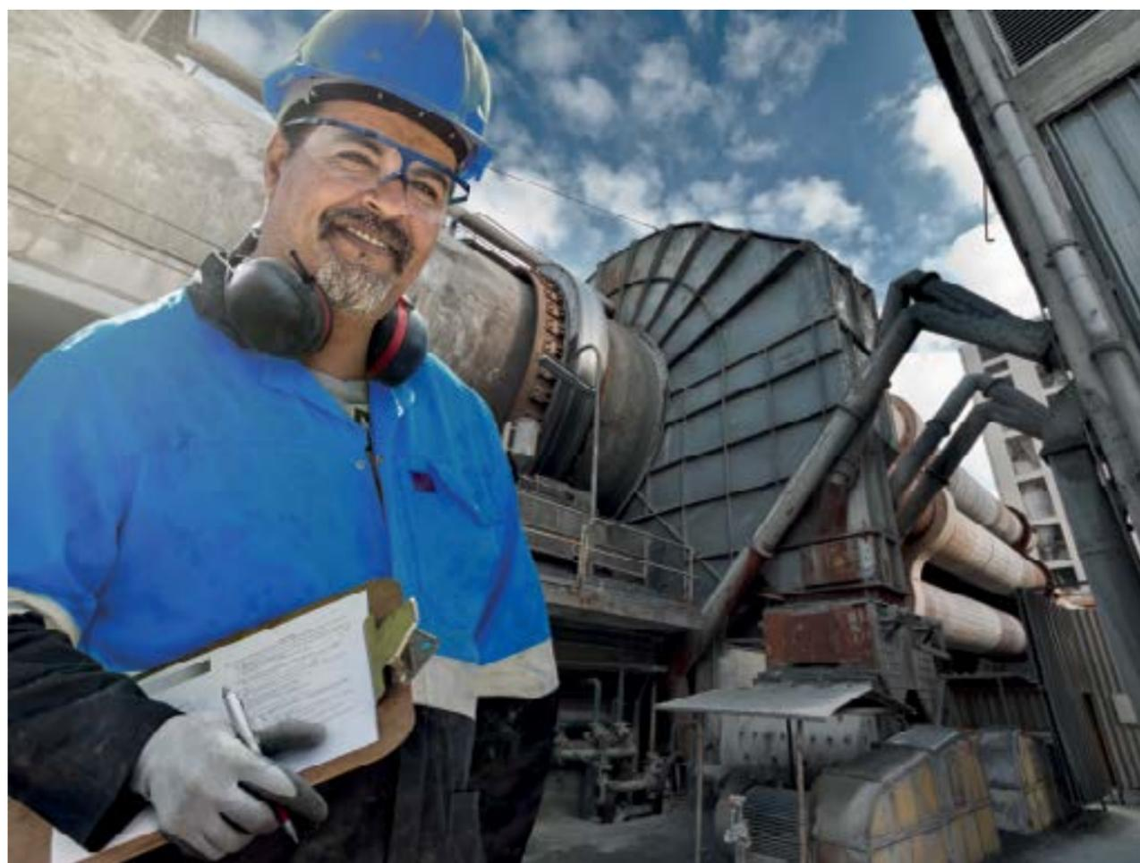
Para unidades de transmissão lubrificadas com CEPLATTYN, nossos engenheiros de serviço realizam inspeções periódicas durante toda a vida útil. O engenheiro de serviço faz medições abrangentes (por exemplo, vibrações, temperaturas dos flancos do dente), que são registradas no FUCHS LUBRICANTS INSPECTOR, um sistema de documentação online que está disponível para nossos clientes a qualquer momento.
