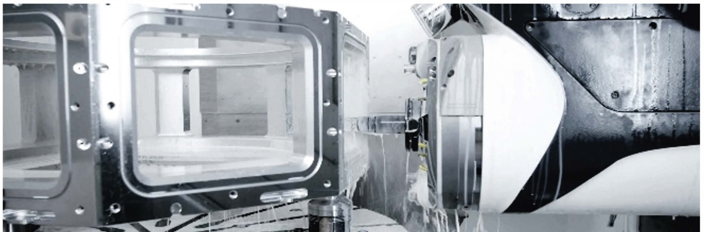
Abbildung 3: Hochleistungszерпанг mit ECOCOOL GLOBAL 1000
