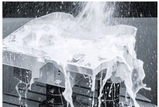
Abbildung 2: Fräsen von Aluminium 5083 mit ECOCOOL SCE-IDM
